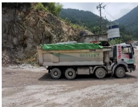
运输车辆遮盖措施
