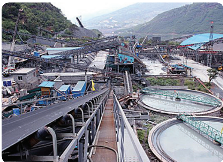
白鹤滩水电站三滩砂石加工及混凝土生产废水处理系统
