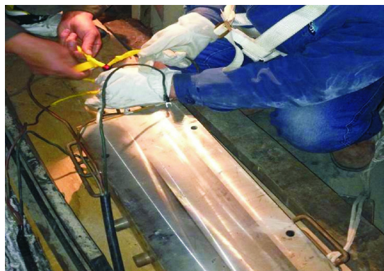
图3 简易硫化机现场电线搭接图
