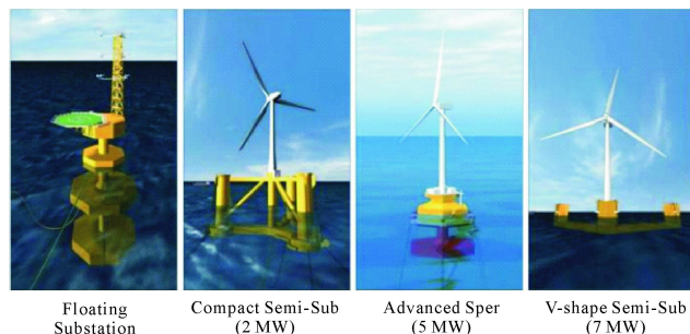
图 15 福岛项四种基础型式图
