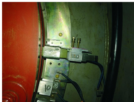
图8 集电环研磨工具安装效果图
