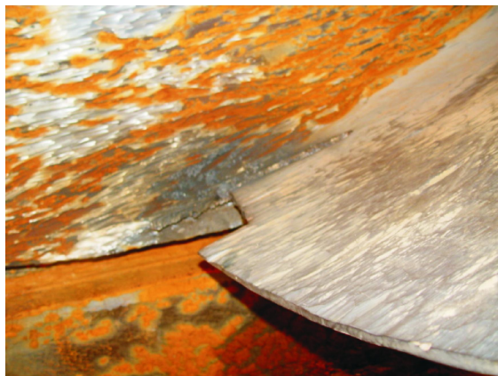
图 2 转轮叶片出水边局部裂纹并脱落图
