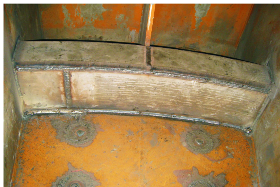
图7 顶盖加高改造修配图
