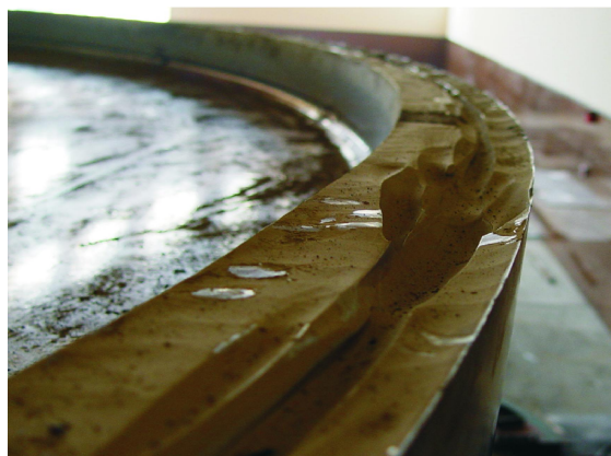
图6 转轮上冠上平面磨蚀情况图(外观)
