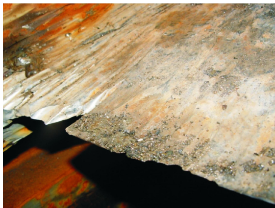
图 1 转轮叶片出水边严重磨蚀图
