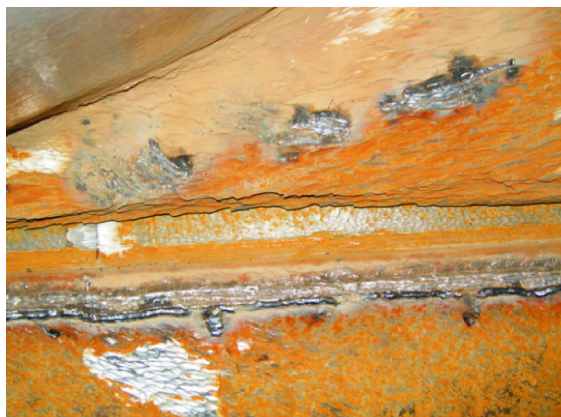
图 2 转轮叶片出水边局部裂纹并脱落图
