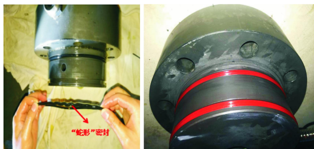
图4 调速系统分段关闭阀连接座密封换型图
