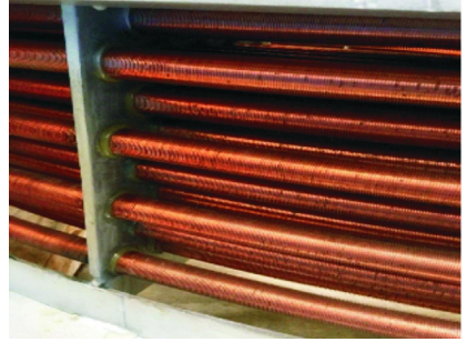
图3 改进后的上导油槽油冷却器图
