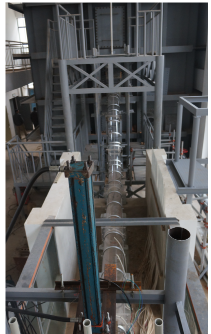
图/向家坝水电站冲沙孔闸门水力学模型
