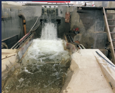
旭龙水电站水工模型试验
