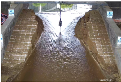
图/大型堰塞坝溃决试验
