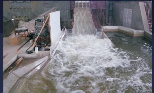
梨园溢洪道水工模型试验
